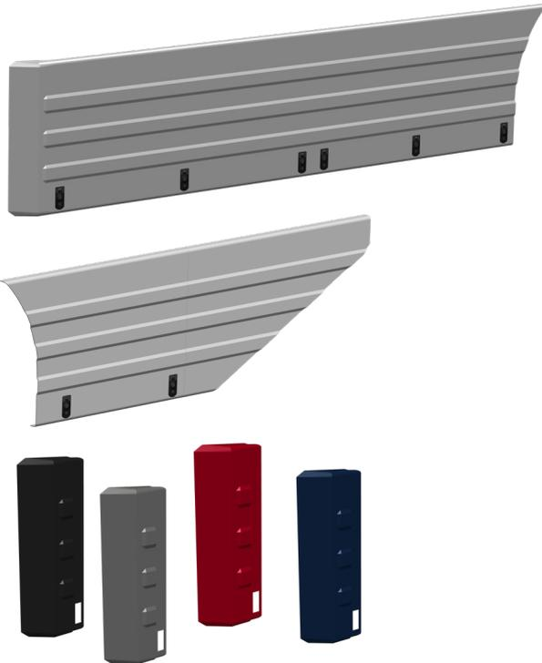
Die Funktion der Parlok Aero Abdeckplatten für Seitenschutzsystem besteht darin, die Turbulenzen unter und hinten dem Anhänger zu verringern, indem der Luftstrom wirtschaftlicher vorbei am Anhänger geleitet wird. Laut CFD-Simulationen und Raupentests werden durch Parlok Seitenschutz um bis zu 13% weniger Luftwiderstand und über 5% weniger Kraftstoffverbrauch erreicht, im Vergleich zu einer Kombination aus Schlepper mit Standard-Sattelauflegern.
